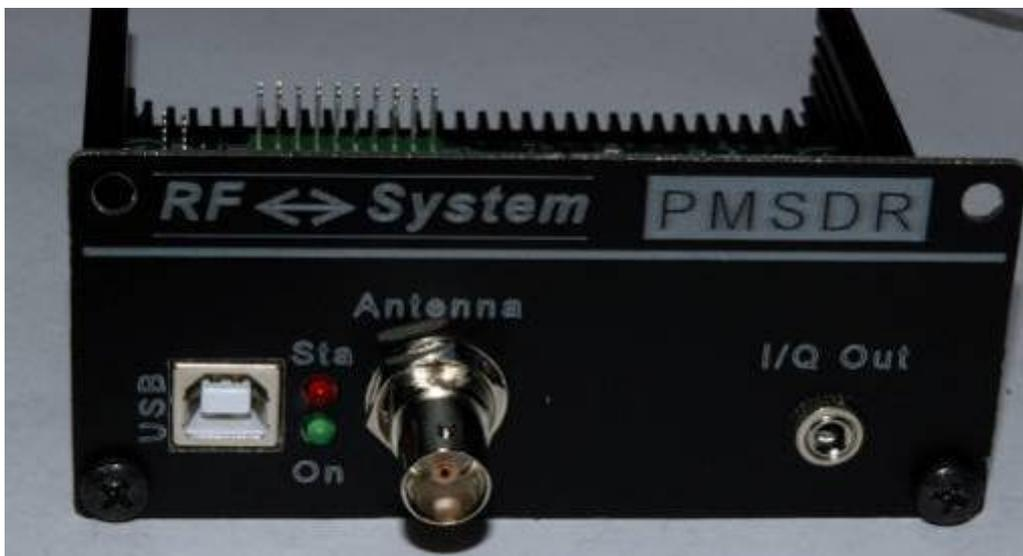
Figura 60 - Pannello posteriore montato.
