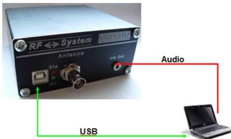
Figura 69 - Schema del collegamento al computer.
