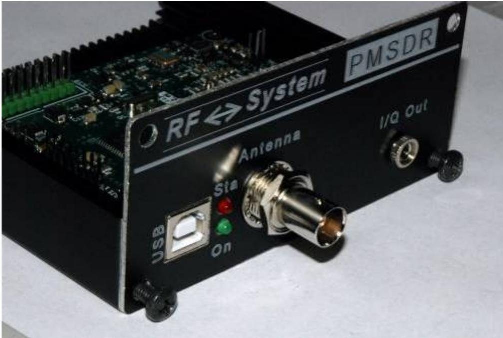
Figura 59 - Fissaggio del pannello posteriore.
