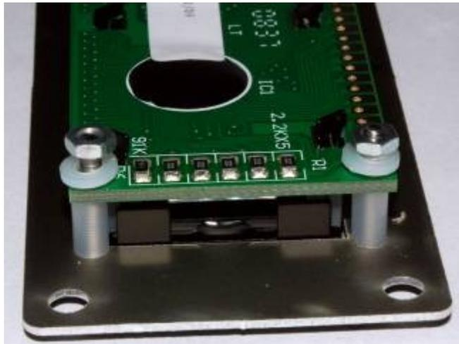
**Figura 65 - Posizione degli isolatori e del display.**
