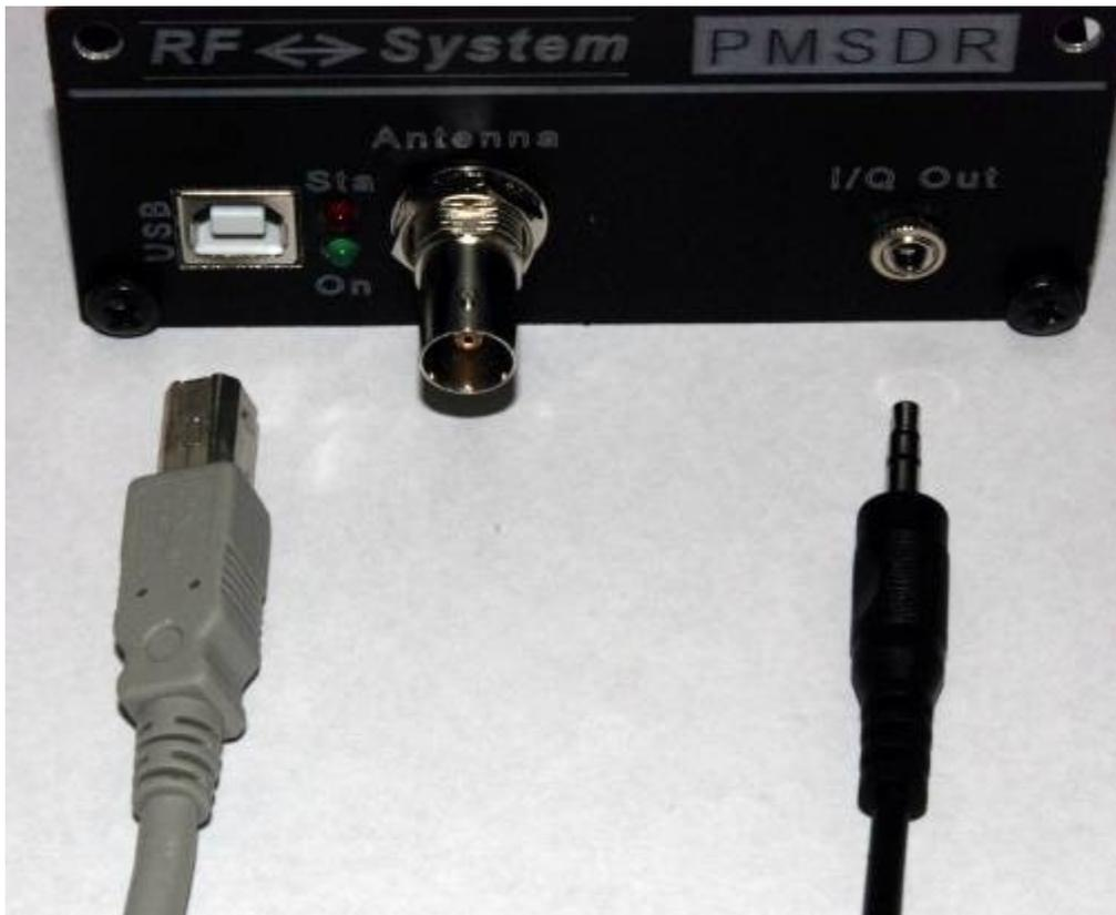
Figura 70 - Collegamento dati ed audio.
