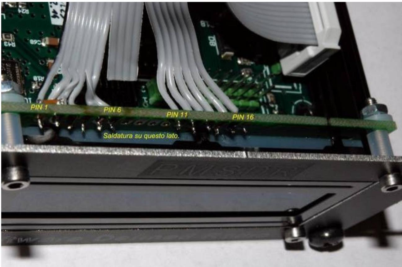
**Figura 68 - Saldatura dei conduttori del display.**
