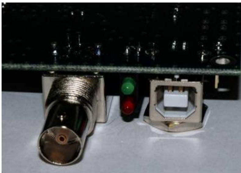
Figura 49 - Spessore sotto il connettore.
