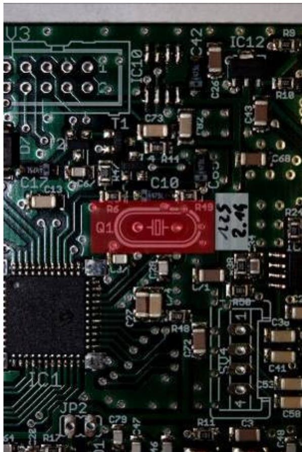
Figura 15 - Posizione di montaggio del quarzo.
