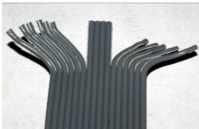
Figura 62 - Separazione dei conduttori.
