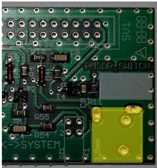
Figura 26 - Posizione del connettore stereo.
