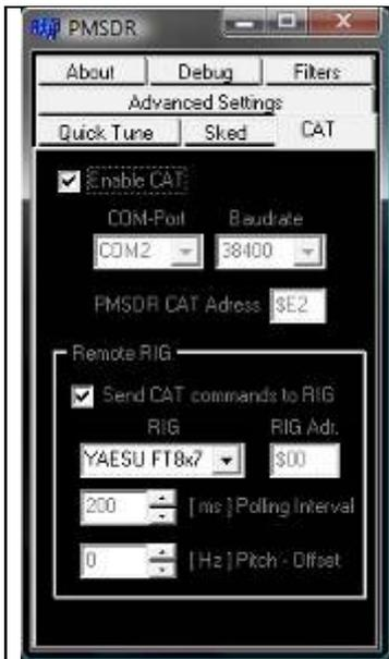
Attraverso questo tab della interfaccia della DLL è possibile impostare la porta COM sulla quale è collegato il ricetrasmittitore ( in questo caso COM 2, attraverso un convertitore USB-RS232) e la velocità di comunicazione della porta stessa. Per la impostazione dei parametri CAT del proprio ricetrasmittitore, consultare il manuale operativo.
