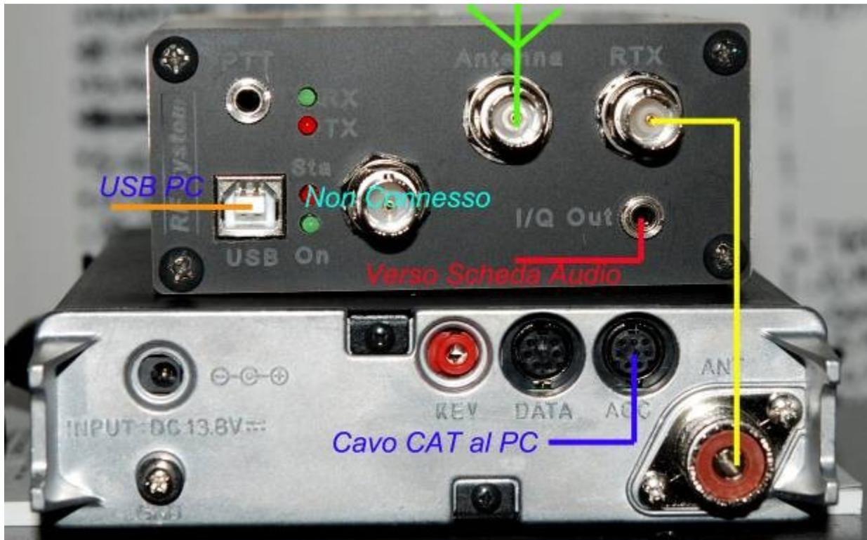
Figura 47 - Schema delle connessioni.
