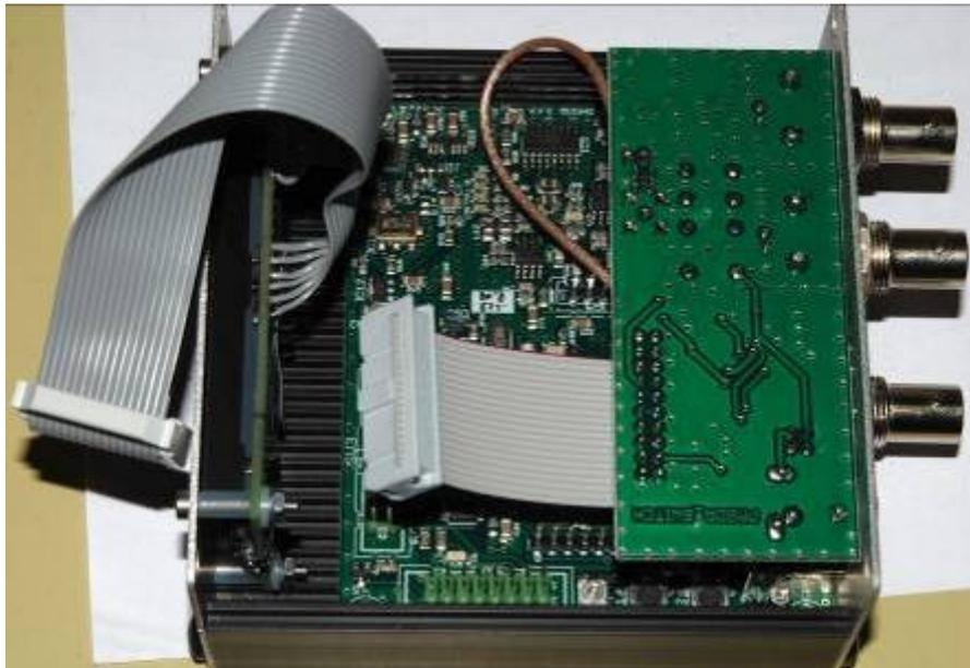
**Figura 42 - Preparazione per il collegamento del flat cable.**
