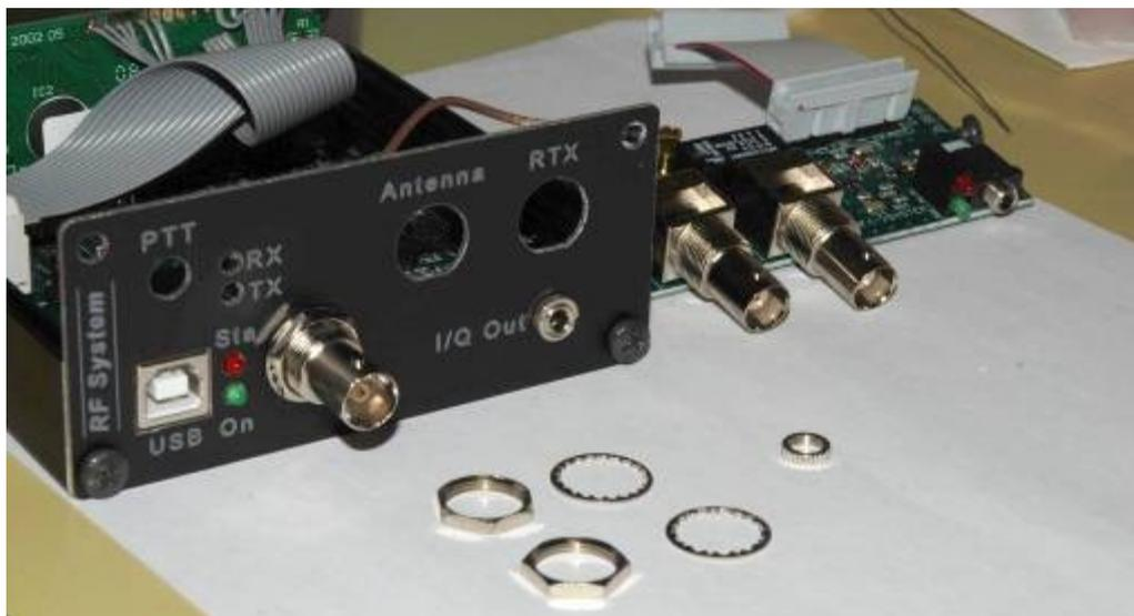
Figura 40 - Montaggio dello switch sul pannello posteriore.
