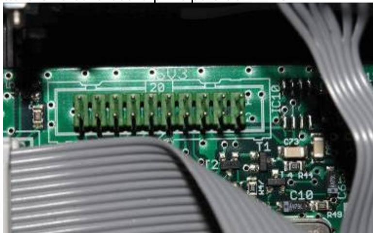
**Figura 36 - Connettore SV3 sulla board PM-SDR.**
