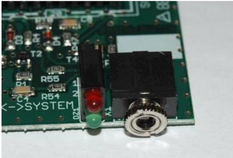
Figura 27 - Connettore stereo.
