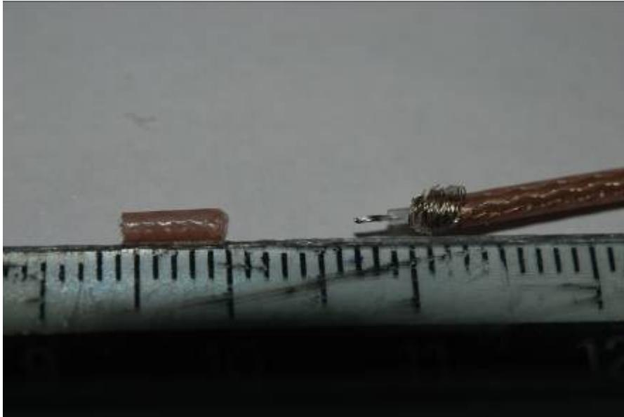
**Figura 31 - Cavo pronto per la saldatura.**
