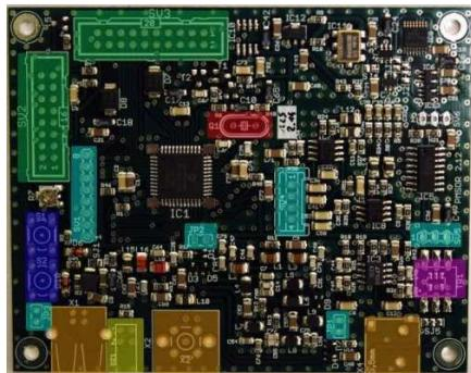
Fig. 9: PMSDR 基板部品挿入図
