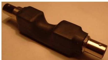
Fig. 163: 熱収縮チューブで覆われて
