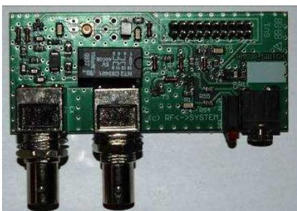
Fig. 25: 完成した T/R スイッチ基板
