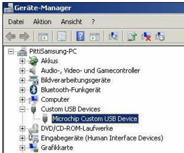
**Fig. 51-2: 適切にインストールされたドライバ**
