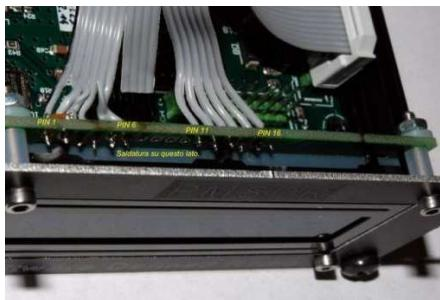
Fig. 17: リボンケーブルのハンダ付け
