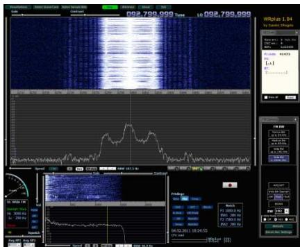
Fig. 124: 48 kHz カードによる FM 受信
