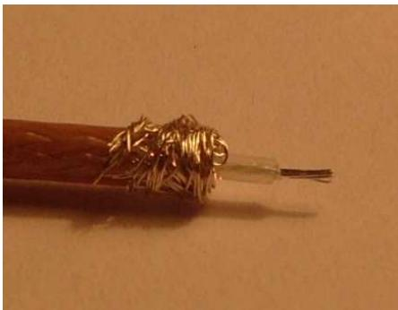
Fig. 26: 同軸ケーブルの準備
