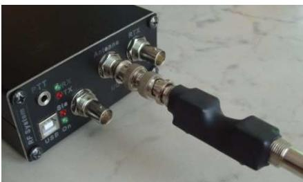
Fig. 164: 接続したアンテナ・アイソレータ
