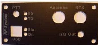
Fig. 21: Type 2 リアパネル; この場合、アンテナジャックを PMSDR の基板に取り付けないでください!
