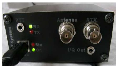
Fig. 50: 電源の供給 ( USB から )
