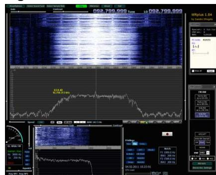
Fig. 123: 96 kHz カードによる FM 受信
