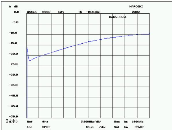
**Bild-173: Return-Loss Input ohne Vorfilter (pass through)**
