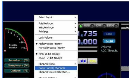
Bild-76: I/Q Eingänge invertieren
