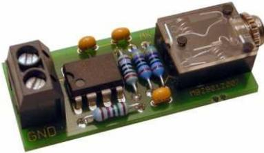
Dieser kleine Tester wird mit 6V bis 9V (Blockbatterie) betrieben, und kostet nur wenige Euro. Hier werden Testsignale generiert, die in die zu prüfende Sound-Card eingespeist werden. Das Schirmbild von HSDR gibt dann Auskunft über Eignung, bzw. Nicht-Eignung. Wenn scheinbar nichts geht, und keiner weiß warum, kann dieses kleine Gerätchen schnell für Klarheit sorgen! Den kompletten Tester können Sie bspw. hier [\[11\]](#) beziehen.
