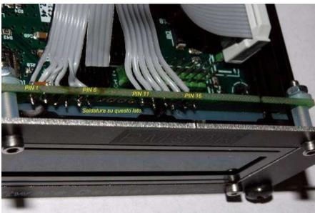
**Bild-17: Flachbandkabel einlöten**
