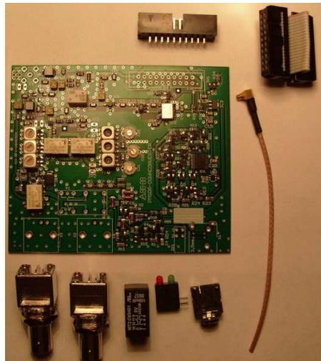
**Bild-5: Bausatz Down-Converter**
